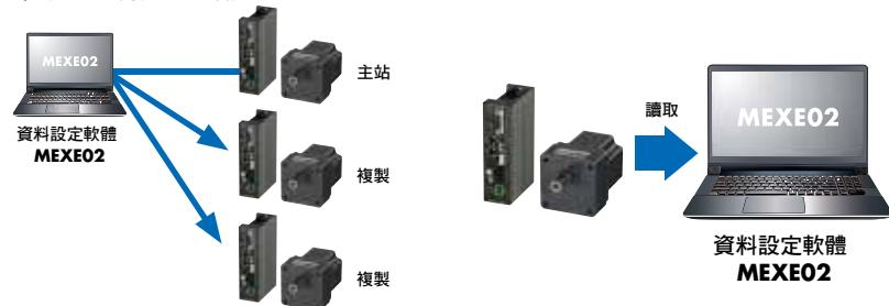
同時使用多台裝置時，可將運轉資料複製到驅動器內，或讀取驅動器端的資料。有助於縮短系統的啟動時間。
