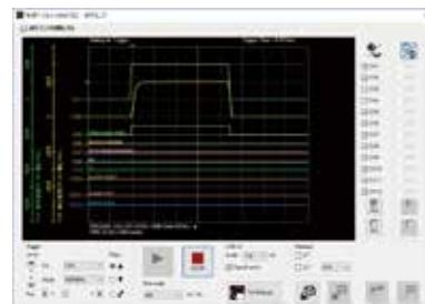
可在示波器的示意圖中，監視馬達的運轉狀態和I/O信號的狀態。
