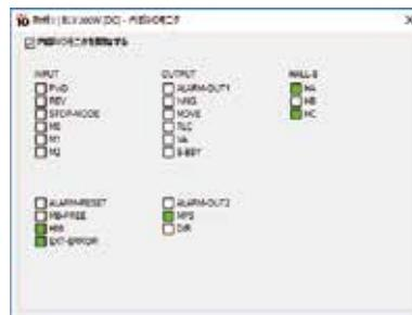
可監視驅動器的輸出入信號及驅動器檢知的霍爾檢知器信號。
