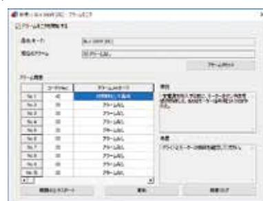
可確認驅動器的Alarm履歷或執行Alarm重設、清除Alarm履歷。
