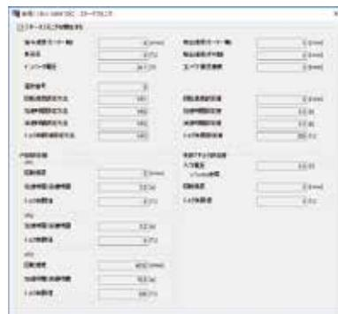
可透過監視功能確認馬達的檢知速度、負載率等目前的馬達狀態或運轉資料的設定方法、設定值的目前狀態。
